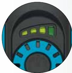
4-stufige Batterie- und Ladestands-Anzeige sowie Dimmschalter auf Rückseite
