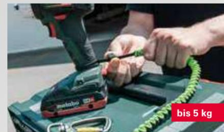
**Werkzeugsicherungsgurt DS bis 5 kg**
